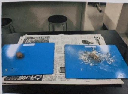
図1. れいぞう庫に保管していた土器粘土(左)と粉末に水をくわえて作った粘土(右)。
